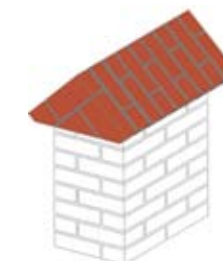
Pokrycie muru w formie dachu dwuspadowego.
