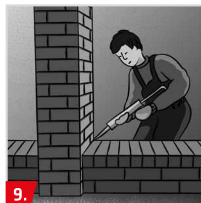
Wypełnianie szczelin np. kitem uszczelniającym
