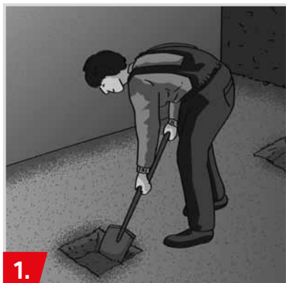
Przygotowanie fundamentów pod słupy ogrodzeniowe
